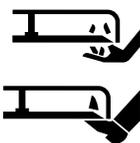
Ne pas ouvrir ou déposer les capots de sécurité tant que le moteur tourne
