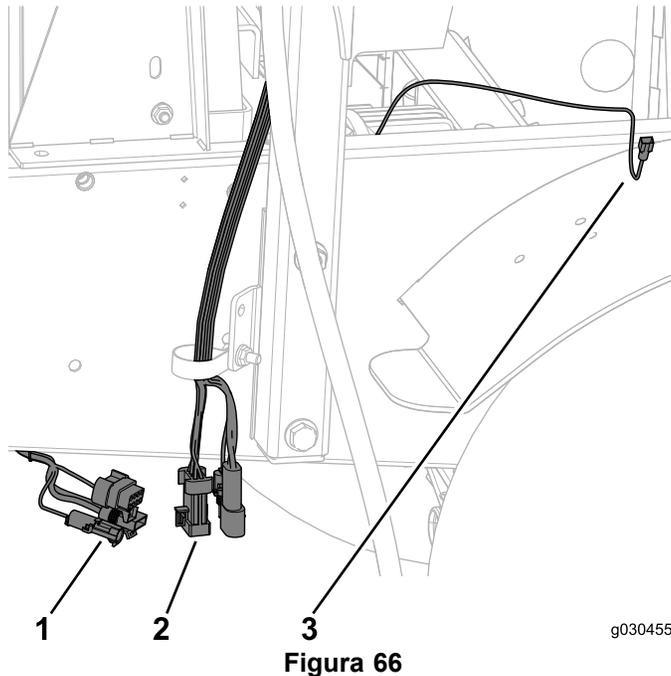
1. Cablaggio preassemblato proveniente dalla macchina
