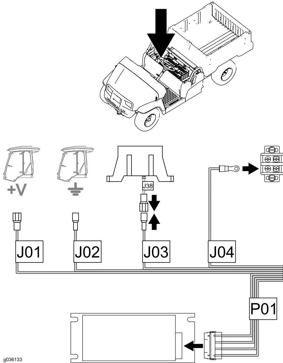
**Remarque:** Utilisez des serre-câbles pour attacher le faisceau de câblage à l'écart des pièces coupantes ou mobiles.
