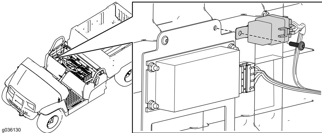
**Remarque:** Utilisez des serre-câbles pour attacher le faisceau de câblage à l'écart des pièces coupantes ou mobiles.
