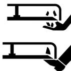
Schutzbleche nie bei laufendem Motor öffnen oder entfernen.
