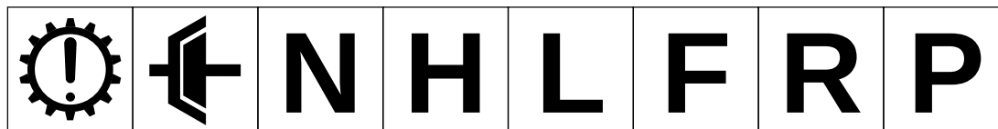
Defect transmissie Koppeling Neutraalstand Hoog Laag Vooruit Achteruit Parkeerstand
