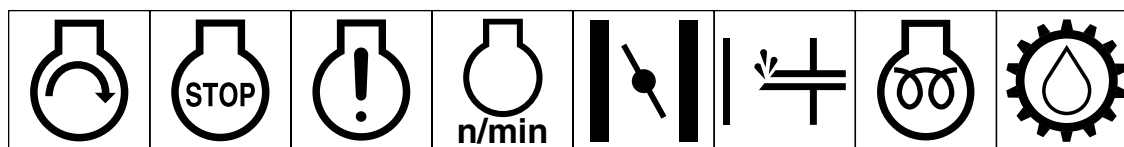
Arranque del motor Parada del motor Fallo/avería del motor Velocidad giro/frecuencia motor Estrangulador Cebador (ayuda arranque) Precalentamiento eléctrico (ayuda arranque) Aceite de transmisión
