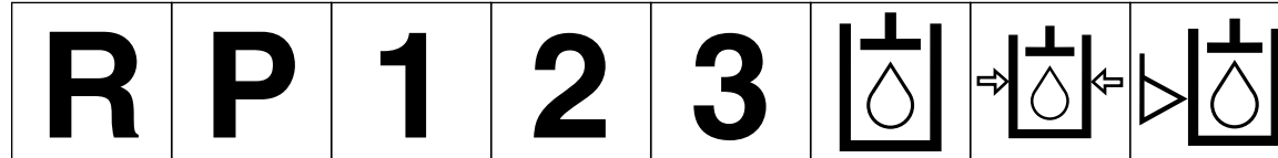
Para trás Estacionamento Primeira mudança Segunda mudança Terceira mudança (podem ser utilizados outros números até que o número máximo de mudanças para marcha para frente seja atingido) Óleo hidráulico Pressão do óleo hidráulico Nível do óleo hidráulico
