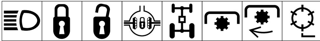
Scheinwerfer    Verriegeln    Entriegeln    Differentialsperre    Allradantrieb    Zapfwelle    Drehzahl -
