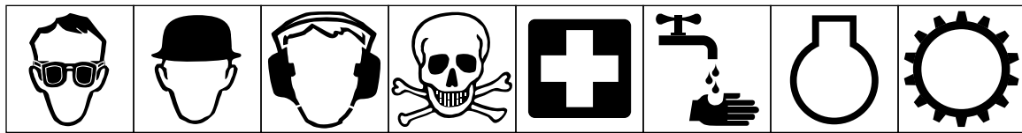
Oogbescherming verplicht Veiligheidshelm verplicht Gehoorbescherming verplicht Gevaar, giftige stoffen Eerste hulp Spoelen met water Motor Overbrenging
