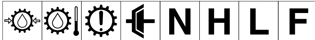
Transmissieoliedruk Transmissieolietemperatuur Defect transmissie Koppeling Neutraalstand Hoog Laag Vooruit
