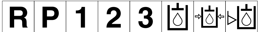
Bakåt Parkering Första växeln Andra växeln Tredje växeln (andra tal kan användas tills max växelantal framåt uppnås) Hydraulolja Hydrauloljetryck Hydrauloljenivå
