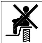
MITFÜHREN VON PASSAGIEREN AUF DIESER MASCHINE NUR AUF DEM BEFAHRERSITZ & WENN DIE SICHT DES FÄHRERS NICHT BEEINTRÄCHTIGT WIRD
