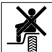
SOLO SE PUEDE MONTAR EN LA MAQUINA EN EL ASIENTO DEL PASAJERO, Y ESTO UNICAMENTE SI NO SE ESTORBA LA VISTA DEL CONDUCTOR
