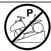
NIE AN HÄNGEN ABSTELLEN. VOR VERLASSEN DES FAHRERSITZES, DAS FAHRPEDAL AUF NEUTRAL STELLEN, ALLE GERÄTE AUF DEN BODEN ABSENKEN, DEN ZÜNDSCHELSEL AUF "AUS" STELLEN UND ZIEHEN.
