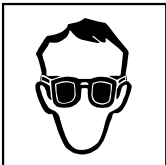
PORTARE OCCHIALI DI PROTEZIONE
