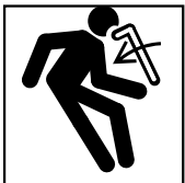
PERICOLO DI ENERGIA IMMAGAZZINATA, CONTRACCOLPO O MOVIMENTO VERSO L'ALTO
