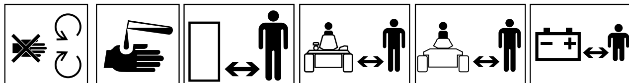
VERNENE MÅ IKKE ÅPNES ELLER FJERNES MENS MOTOREN GÅR ETSENDE VÆSKER, KJEMISKE BRANNSÅR PÅ FINGRE OG HENDER STÅ I TRYGG AVSTAND FRA MASKINEN STÅ I TRYGG AVSTAND FRA MASKINEN STÅ I TRYGG AVSTAND FRA MASKINEN HOLD BARNA I TRYGG AVSTAND FRA BATTERIET
