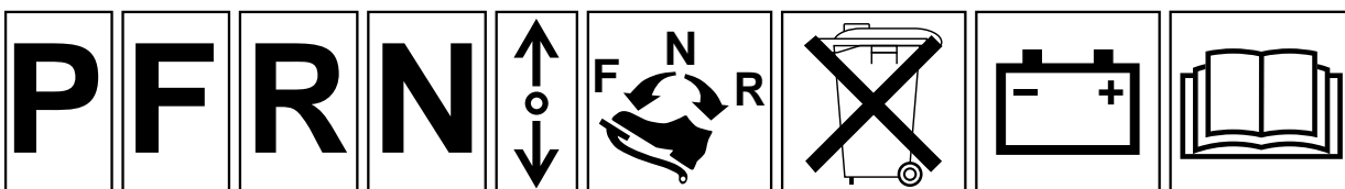
PARKER FREMOVER BAKOVER NØYTRAL KONTROLLENS ARBEIDSRETNING, TO RETNINGER BRUK AV FREMDRIFTS-PEDALEN MÅ IKKE KASTES I VANLIG SØPPEL BATTERIETS LADETILSTAND LES FØRERHÅNDBOKEN
