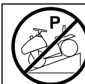
ÄLÄ KOSKAAN PYSÄKÖI RINTEeseen. ENNEN KUIN POISTUT KULJETTAJAN PAIKALTA SIIRÄ AJOPOLJIN VAPAA-ASENTOON, LASKE TYÖVÄLINEET MAAHAN, KÄÄNNÄ VIRTA-AVAIN ASENTOON 'OFF' JA OTA SE POIS VIRTALUKOSTA.
