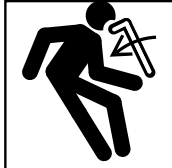
VARAUTUNUTTA ENERGIAA, POTKAISU- TAI PONNAHDUSVAARA
