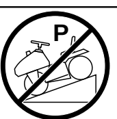
MASKINEN MÅ ALDRIG PARKERES PÅ EN SKRÅNING. INDEN MAN REJSE SIG FRA FØRERSÆDET, SÆT MANØVREPEDALEN I FRIGEAR, SÆNK REDSKABERNE NED PÅ JORDEN, DREJ TÆNDINGSNØGLEN TIL "AFBRUDT" (OFF) OG TAG NØGLEN UD.
