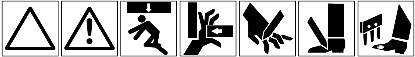
SÍMBOLO DE ALERTA DE SEGURIDAD AVISO DE SEGURIDAD PELIGRO GENERAL APLASTAMIENTO DEL CUERPO ENTERO, DESDE ARRIBA APLASTAMIENTO DE LA MANO, FUERZA LATERAL SECCIONAMIENTO DE DEDOS O MANO SECCIONAMIENTO DE UN PIE APLASTAMIENTO O HERIDA EN EL PIE, CABEZAL PERFORADOR
