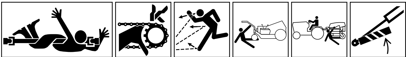
PUEDE ENREDARSE EL CUERPO ENTERO – EJE DE TRANSMISIÓN DE ACCESORIOS DEDOS O MANOS ENREDADOS EN LA TRANSMISIÓN DE LA CADENA OBJETOS ARROJADOS O VOLANTES, EXPOSICIÓN DE TODO EL CUERPO ATROPELLO POR HC 4000 AERATOR ATROPELLO POR HC 4000 AERATOR ASEGURE EL CILINDRO ELEVADOR CON EL DISPOSITIVO DE CIERRE ANTES DE ENTRAR EN ZONA PELIGROSA
