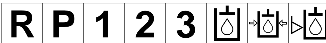
Para trás Estacionamento Primeira mudança Segunda mudança Terceira mudança (podem ser utilizados outros números até que o número máximo de mudanças para marcha para frente seja atingido) Óleo hidráulico Pressão do óleo hidráulico Nível do óleo hidráulico
