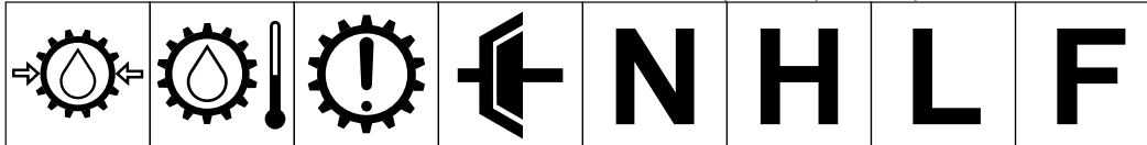
Pressão do óleo da transmissão Temperatura do óleo da transmissão Falha/avaria da transmissão Embraiagem Ponto morto Alto Baixo Para frente
