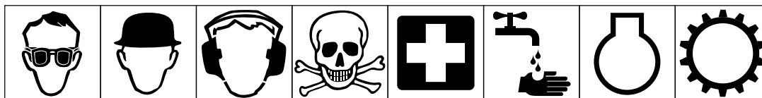
Ögonskydd måste användas Hjälmskydd måste användas Hörselskydd måste användas Fara, förgiftningsrisk Första hjälpen Spola med vatten Motor Transmission
