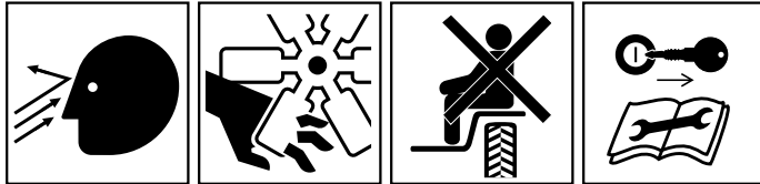
AUSGEWORFENE ODER FLIEGENDE GEGENSTÄNDE – GEFAHR FÜR GESICHT AMPUTATIONSGEFAHR FÜR FINGER ODER HAND, MOTORVENTILATOR MITFÜHREN VON PASSAGIEREN AUF DIESER MASCHINE NUR AUF DEM BEFAHRERSITZ & WENN DIE SICHT DES FAHRERS NICHT BEEINTRÄCHTIGT WIRD VOR WARTUNGS- ODER REPARATURMASSNAHMEN, MOTOR ABSTELLEN UND ZÜNDSCHLÜSSEL ZIEHEN
