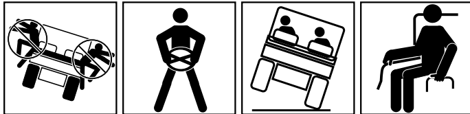
NICHT VON KIPPENDER MASCHINE ABSPRINGEN FESTHALTEN UND FESTEN FUSS FASSEN ENTOEGEN DER KIPPRICHTUNG NEIGEN HÜFTHALTERUNG UND HANDGRIFF FESTHALTEN, FESTEN FUSS FASSEN
