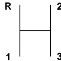
**WICHTIG: Das Getriebe nur von vorwärts auf rückwärts schalten, wenn sich die Maschine im kompletten Stillstand befindet, andernfalls folgen schwere Getriebeschäden.**
