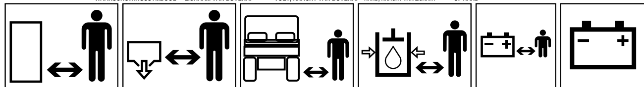
BLIJF OP VEILIGE AFSTAND VAN DE MACHINE BLIJF OP VEILIGE AFSTAND VAN DE AFVOERTANK BLIJF OP VEILIGE AFSTAND VAN DE MACHINE BLIJF OP VEILIGE AFSTAND VAN DE HYDRAULISCHE OLIEKLEP HOUD KINDEREN OP VEILIGE AFSTAND VAN DE ACCU LAADCONDITIE ACCU
