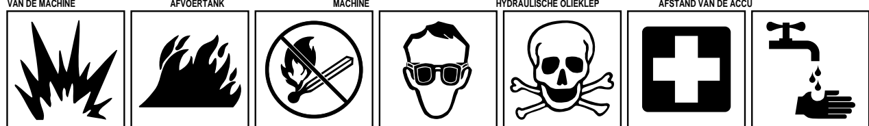
EXPLOSIE OPEN VUUR VUUR, OPEN LICHT EN ROKEN VERBODEN DRAGEN VEILIGHEIDSBRIL VERPLICHT PAS OP, VERGIF EERSTE HULP AFSPOLEN MET WATER
