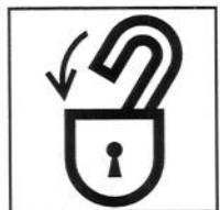
VERROUILLER LA SECURITE AVANT D'ABORDER UNE ZONE DANGEREUSE
