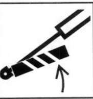
BLOQUER LE VERIN DE LEVAGE AVEC LE DISPOSITIF APPROPRIE AVANT D'ABORDER UNE ZONE DANGEREUSE
