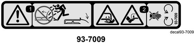
1. Advertencia – no haga funcionar la máquina con el deflector elevado o retirado; mantenga colocado el deflector.
