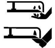
Para evitar el fallo de la cuchilla mientras se distribuyen fertilizantes orgánicos, utilice un refuerzo para la cuchilla cuando la cortadora esté equipada con un distribuidor de fertilizantes.
