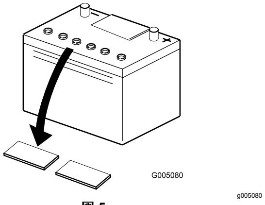
3. 各セルの電極板が液面下 6 mm程度に水没するまで、電解液を慎重に入れる **図 6**。
