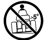
Umkippen der Maschine, nicht abwärts an Gefällen über 10 Grad einsetzen
