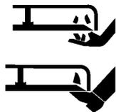
Verletzungsgefahr für Hände & Arme, Riemenantrieb
