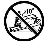
Umkippen der Maschine, nicht aufwärts an Gefällen über 15 Grad einsetzen
