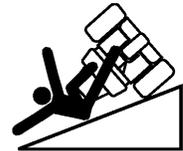
Umkippen der Maschine, nicht seitlich an Gefällen über 5 Grad einsetzen
