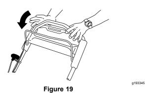
Important: Lorsque vous relâchez la barre de commande, les lames doivent s'arrêter en moins de 3 secondes. Si ce n'est pas le cas, cessez immédiatement d'utiliser la machine et adressez-vous à un dépositaire réparateur agréé.
