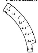
ON LEFT SIDE OF HEIGHT-OF-CUT PLATE (Part No E633706)
