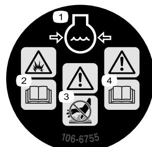
1. Охлаждающая жидкость двигателя находится под давлением.
