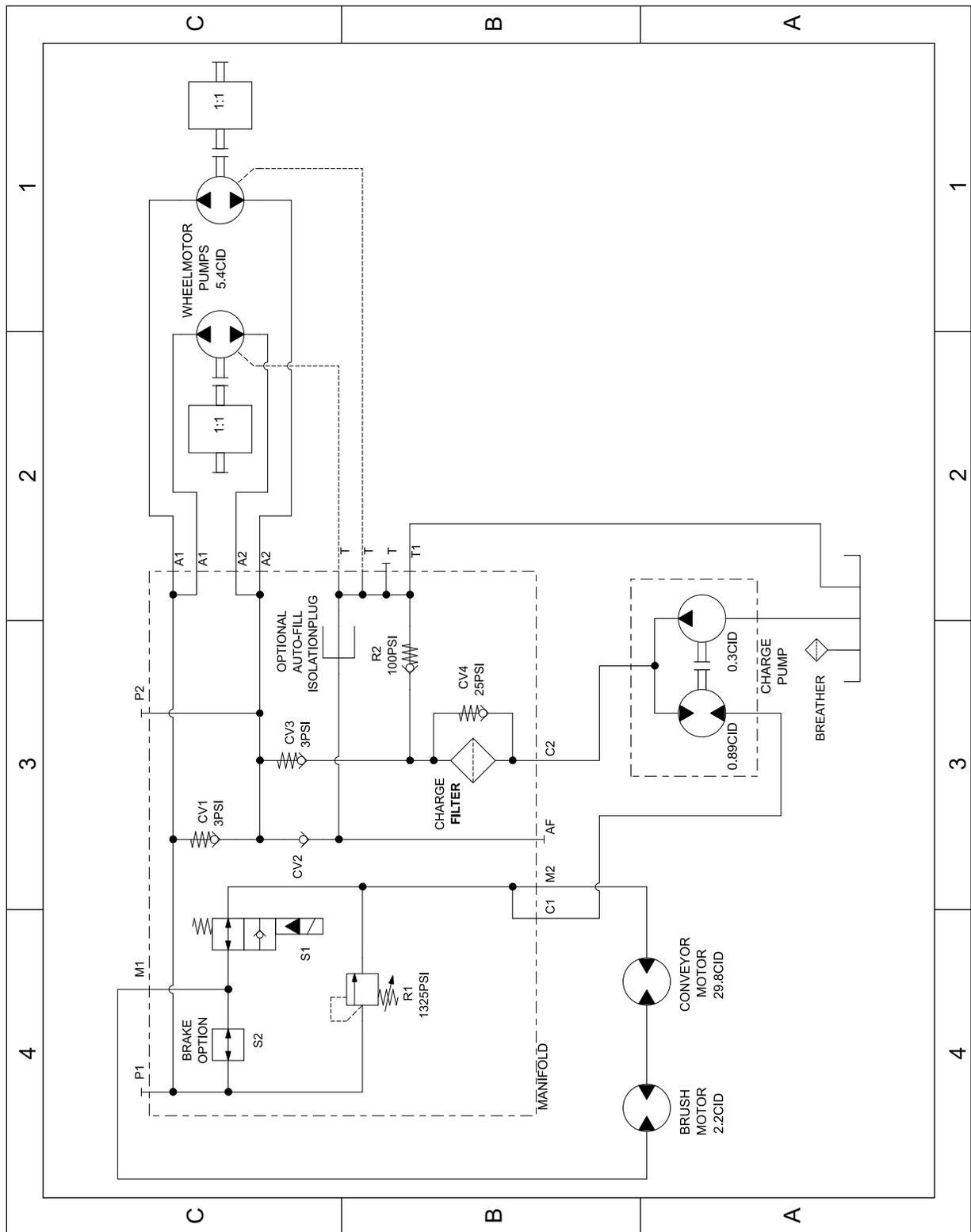
Гидравлическая схема 138-5972 (Rev. A)
