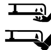
La lame des tondeuses équipées d'une prise de paillage doit être protégée par une plaque de renfort
