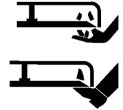
Per evitare la rottura della lama in sede di taglio di foglie secche, quando il tosaerba è dotato di tampone per foglie secche, utilizzate l'elemento di rinforzo della lama
