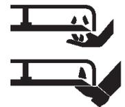
Warten, bis alle Maschinenkomponenten vollständig stillstehen, bevor sie berührt werden. (Die Schnittmesser drehen sich noch, wenn die Maschine bereits abgestellt wurde.)
