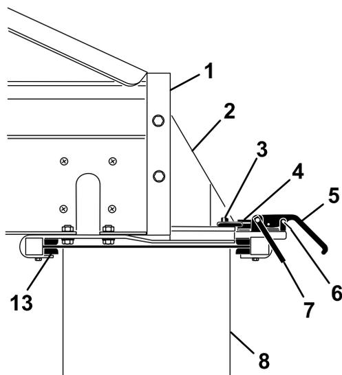
5. Выведите задний узел хомута дополнительного навесного орудия из пазов быстрого подсоединения (Рисунок 48).
