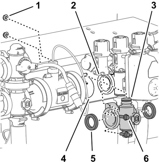
個別ブームマニホールドバルブの取り外し (ページ 75) で取り外したフランジヘッドボルト $\frac{1}{4}$ " x  $\frac{3}{4}$ "2本とフランジロックナット $\frac{1}{4}$ "2個を使用する。
