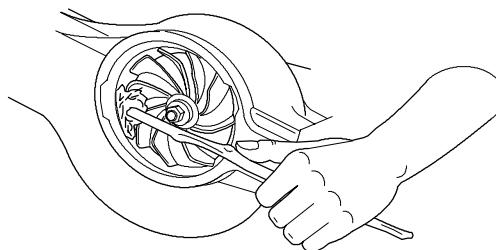
4. Compruebe cualquier posible daño en el rotor. Si está dañado, póngase en contacto con su Concesionario Autorizado Toro.
