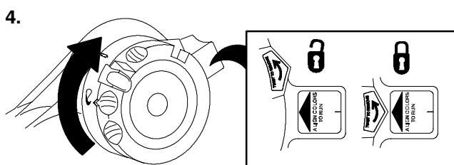
**IMPORTANTE:** El soplador no funcionará a menos que la tapa de entrada inferior se gire hasta el fondo en sentido horario, quedando bloqueada en su posición (paso 4).
