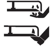
Pour éviter une défaillance de la lame, utiliser le renfort de lame lors de tout emploi de l'obturateur de paillage
