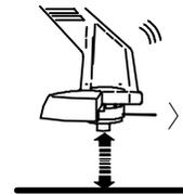
**Nota:** La cuchilla situada debajo del guardahierba cortará automáticamente la tanza de corte a la longitud correcta.
