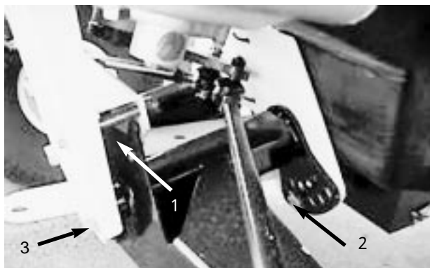
図 18 1. リミットボルト 2. 乗車高さ調整ボルト 3. センタボルト
