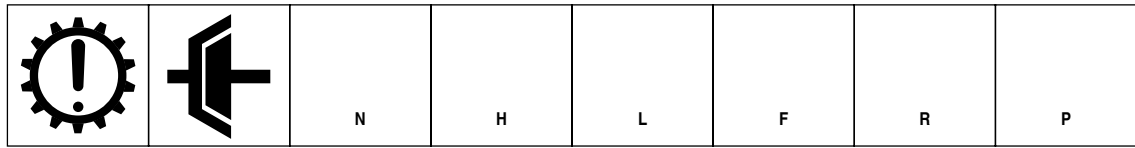
Gearkassesvikt Clutch Nøytral Høyt Lavt Fremover Bakover Parkering
