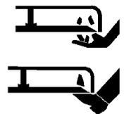
**Benutzen Sie, um einen Messerbruch beim Recyclen zu vermeiden, Messerverstärkungen, wenn der Mäher mit einem Recyclerverschluss ausgerüstet ist**
