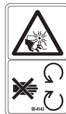
OP SCHERM VAN KOELLUCHTVENTILATOR (Onderdeelnr. 95-4143)
