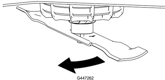
3. Mesurez la distance entre la pointe de la lame et la surface plane.
