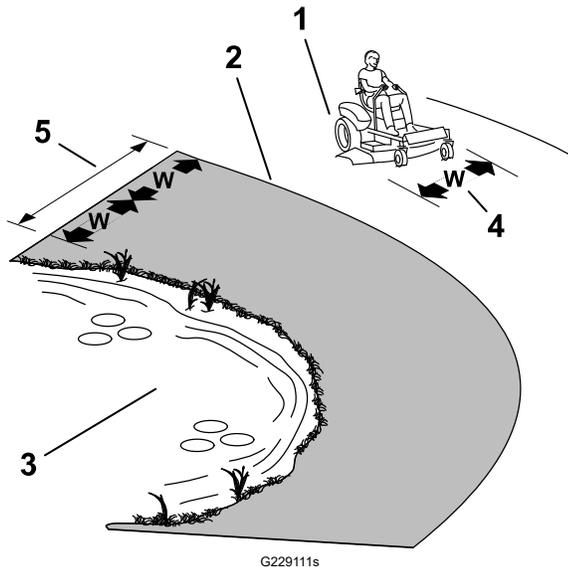
① Zone de sécurité – utiliser la machine ici sur les pentes de moins de 15° ou sur les terrains plats
