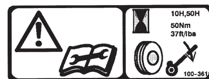
Auf Kurbelscheibe (Teilenr. 100-3611) Ziehen Sie die Spannbüchsen nach jeweils 10 und 50 Stunden fest
