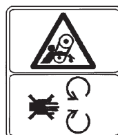
Am Rahmen unter der Haube (Teilenr. 100-3612) Lassen Sie alle Schutzvorrichtungen montiert
