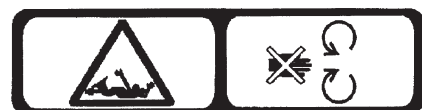
En el bastidor delantero (Pieza N° 100-3613) PELIGRO TOMA DE FUERZA No retire el protector
