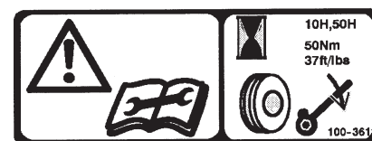
En la polea del cigüeñal (Pieza N° 100-3611) Vuelva a apretar el buje Taper Lock después de 10 horas y 50 horas
