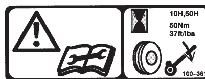
Sur la poulie de manivelle (Réf. 100-3611) Resserrer le verrou conique toutes les 10 et 50 heures
