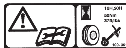
På vevskiva (Artikelnr. 100-3611) Dra åt konlåset efter 10 timmar och 50 timmar
